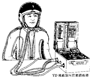
图1 TK-1型密闭头盔、DC-2型代偿服与YD地面加压供氧锻炼器连接图
