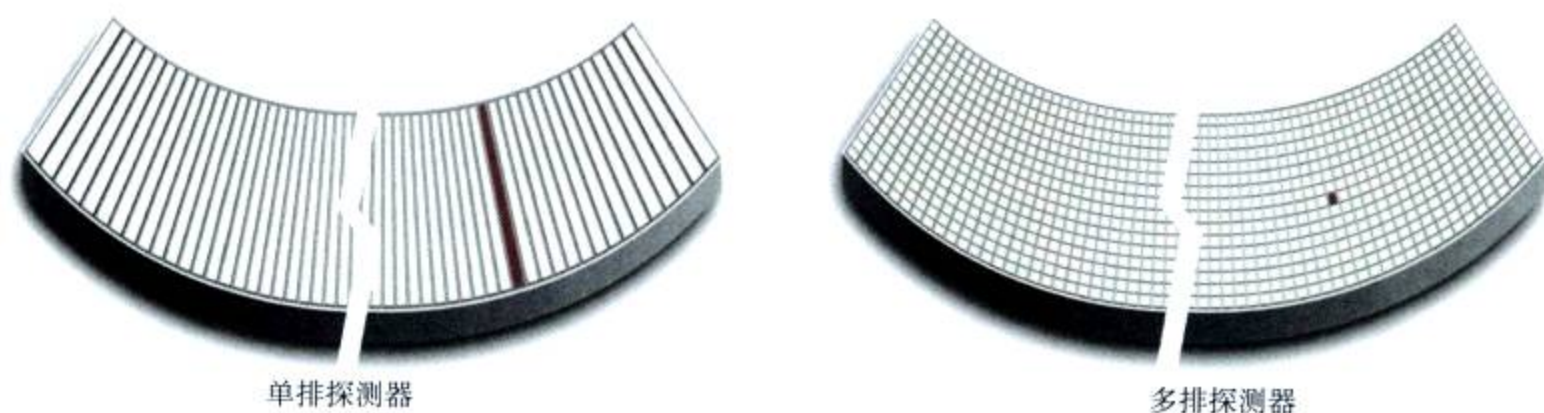
图 1-5 单排与多排 CT 探测器结构上的区别
