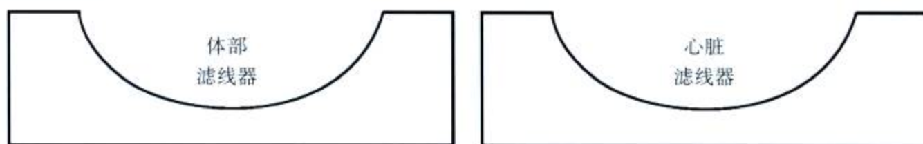
图 2-6 体部滤线器和心脏滤线器形状示意图
