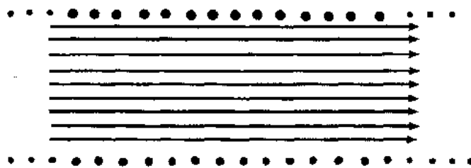
图 7.1 无限长的线管内的均匀磁场
