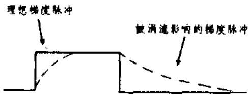
图 5.2 涡流对梯度脉冲波形的影响
