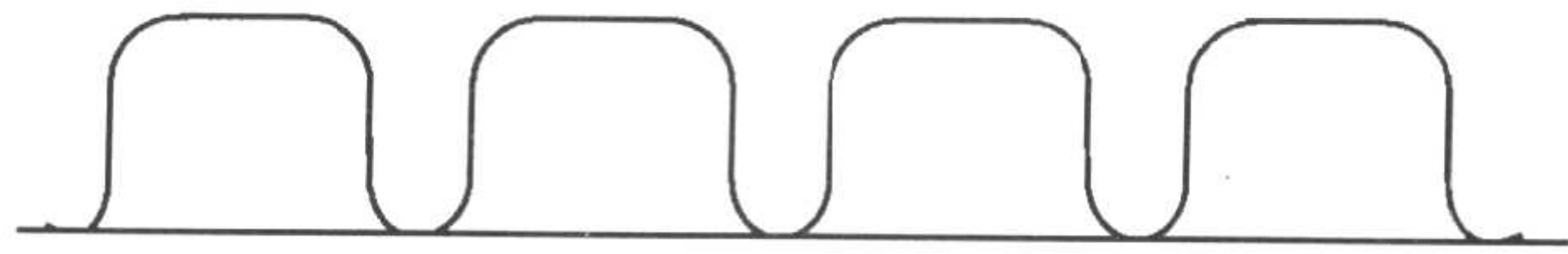
图 18-35 射频脉冲(实际上是它的傅立叶变换)的形态越接近于直角,我们就能够更好地进行连续层面的采集,而不出现层间交叉。
